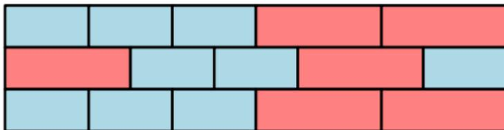
pour être solide, le mur ne doit jamais superposer deux jointures
